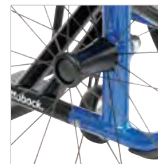
Trajno zavaren položaj pogonskih točkova
