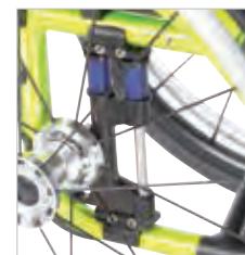
Amortizer pogonskog točka
