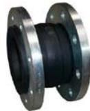
**Flanšinis kompensatorius PN16, dumplės, vidinis atvamzdis ir galai AISI304, dažyti flanšai S235, su ašinio pailgėjimo ribotuvais (nuo DN50), T<sub>min</sub>-40°C/ T<sub>max</sub>+300°C**
