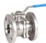
**GENEBRE rutulinis ventilis pilno pralaidumo su ISO TOP flanšu, trumpos konstrukcijos, tarpflanšinis, AISI316 (CF8M), T<sub>min</sub>-20°C/T<sub>max</sub>+180°C**
