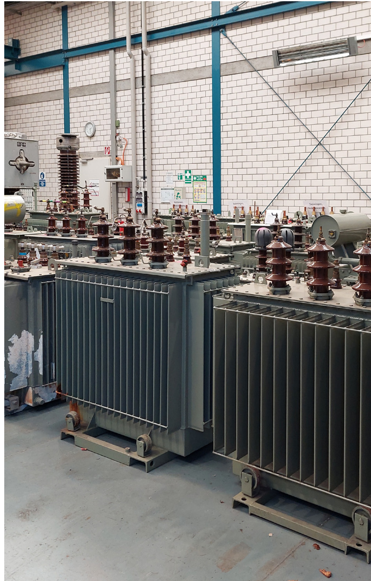
Ölwanne in Altbach: Hier werden die Trafos gebündelt, geprüft und für effizientere Transporte in die Ukraine vorbereitet. Belastete und undichte Transformatoren werden ordnungsmäßig entsorgt.
