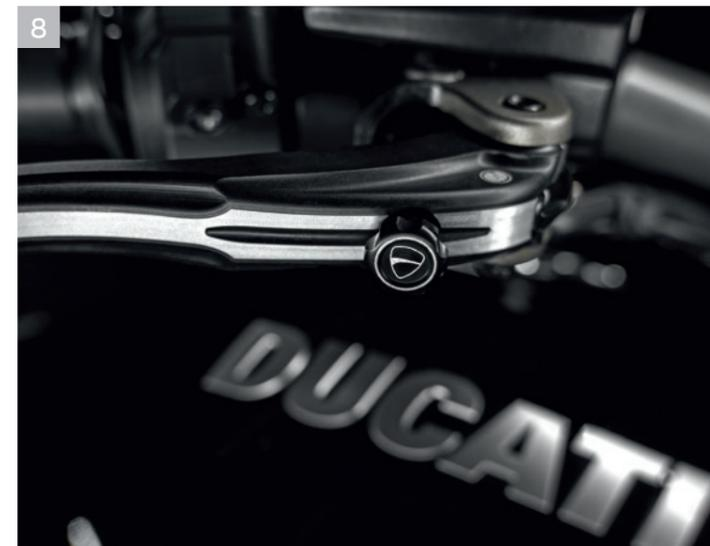
7 8 ビレットアルミニウム製ブレーキレバー/クラッチレバーセット。
