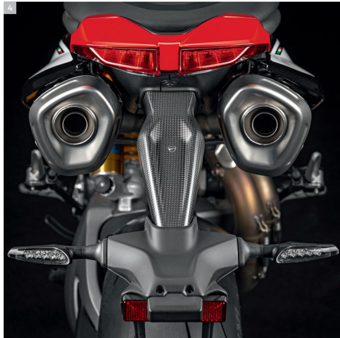
4 カーボン製ナンバープレートホルダー基準適合マウント。
