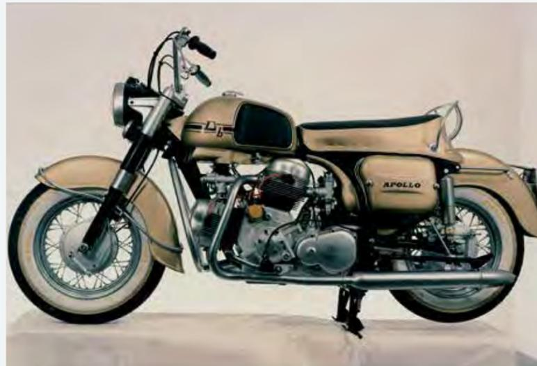
アポロのエンジンは、後にドゥカティのトレードマークとなるL型2気筒を予感させる。
