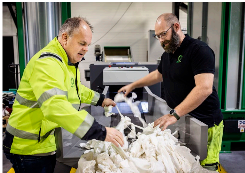
Textilierna matas in i maskinen och kommer ut som fibrer, vilka blir till tråd, textil och slutligen kläder.
