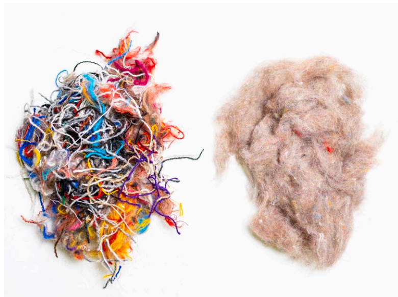
Trådhögen förvandlas till fibertussen när den passerar genom Norsk Textilgjenvinnings högteknologiska anläggning.
