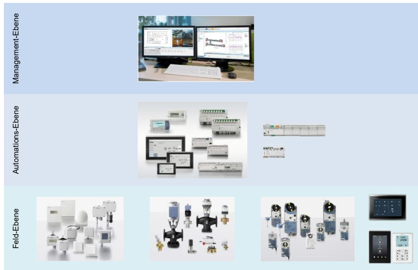
Fig. 7-14 Die 3 Ebenen eines Gebäudeautomations-Systems
