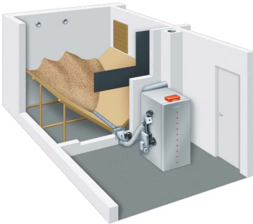
Fig. 3-9 Schnitzelförderung aus Lagerraum mit Schneckensystem (Quelle: Löbbe)
