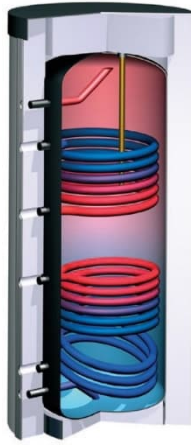
Fig. 3-23 Solarspeicher mit separaten Wärmetauschern für die Solarenergie (unten) und für die Nachheizung (Quelle: TST)
