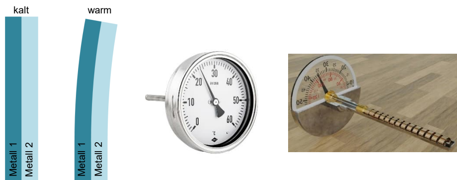
Fig. 2-6 Bimetall-Anwendungen: Bimetall in kaltem und erwärmtem Zustand (links), Bimetall-Thermometer z.B. zur Anzeige von Wassertemperaturen (Mitte; Quelle: Jako, AT) Bimetall-Thermometerelement in Schraubenform (Schnittbild rechts; Quelle: tec-sience.com)
