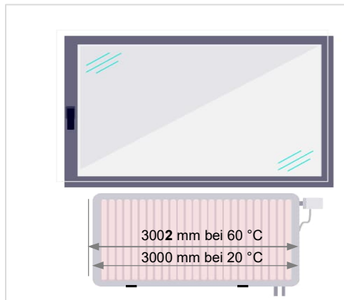
Fig. 2-5 Wärmeausdehnung eines Heizkörpers aus Stahl
