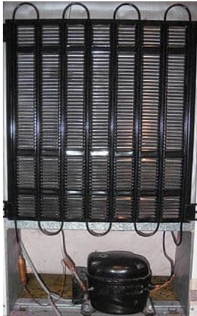
Fig. 4-15 Kondensator-Register Kühlschrank (Quelle: Wikipedia)
