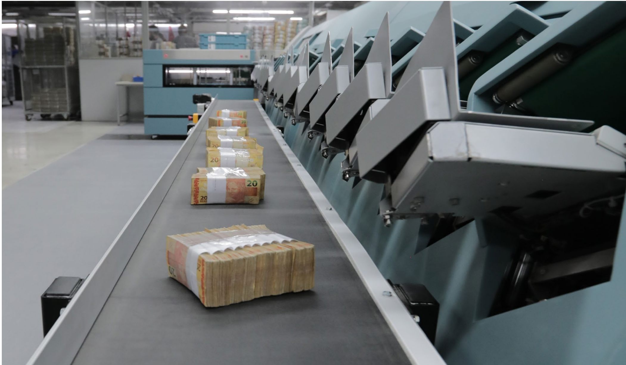
Equipamento de alta performance: a classificadora de cédulas M5 é utilizada para garantir eficiência e segurança ao manuseio das notas.
