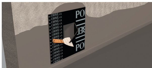
Aplicar banda de refuerzo. Adherente
