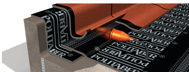
Rematar con lámina autoprottegida. Ejemplo monocapa.
