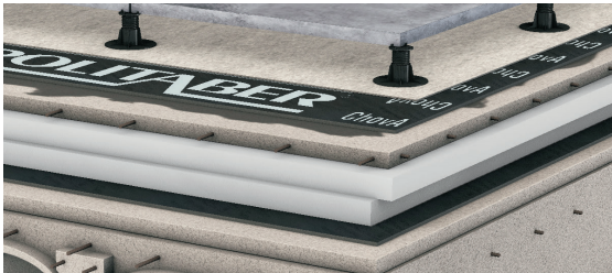
Cubierta transitable acabada con baldosas sobre plots.
