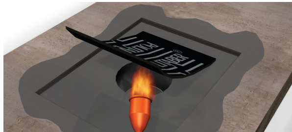
Soldar la pieza de refuerzo (inferior)
