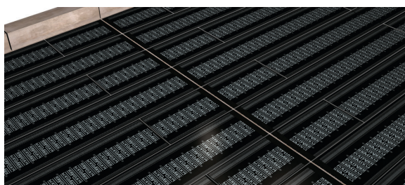
Alineación de los rollos. No coincidencia de solapes transversales
