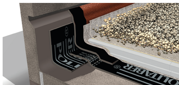
Cubierta invertida. No transitable, acabada con grava.
