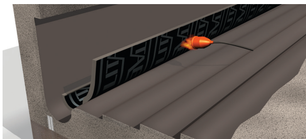
Pieza de refuerzo (inferior)
