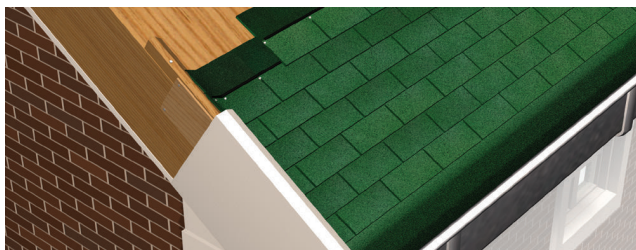
Remates con perfiles metálicos o piezas especiales (laterales)
