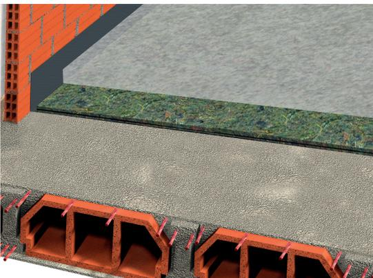
3- Proteger los paneles con un film de polietileno para evitar que absorban la humedad del mortero.
