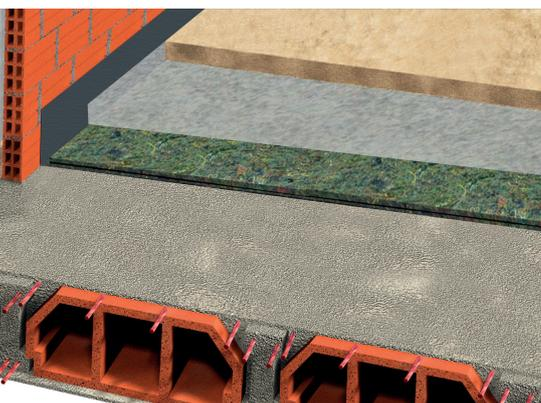
4- Por último, realizar la solera de mortero armada de 50mm de espesor. En cuanto a las dosificaciones y armado de la solera se seguirán las recomendaciones de la dirección facultativa de la obra.
