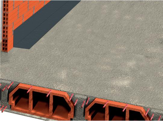
1- Previamente a la instalación del sistema se habrá comprobado que la superficie está limpia, seca y libre de irregularidades. En los encuentros con tabiques y pilares instalar el material ChovAIMPACT® BANDA PERIMETRAL RT para evitar la unión rígida entre solera y paramentos. Adherir la banda perimetral formando una "L" en el encuentro entre suelo y tabiques.
