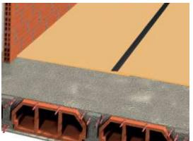
2- Instalar los siguientes tramos de material hasta cubrir por completo la superficie. No realizar solapes quedando la junta a testa.
