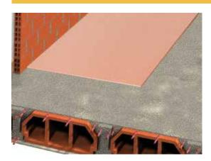
1- Previamente a la instalación de la lámina se habrá comprobado que la superficie esté limpia, seca y libre de irregularidades. A continuación, comenzar a extender la lámina de polietileno.
