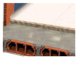
2- Instalar los siguientes tramos de material a testa hasta cubrir la superficie por completo. No es necesario sellar las juntas.
