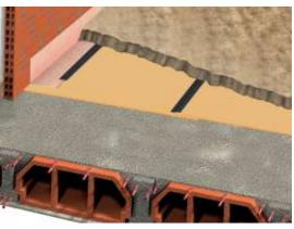
4- Por último, realizar la solera de motero armada de al menos 50 mm de espesor. En cuanto a las dosificaciones y armado de la solera se seguirán las recomendaciones de la dirección facultativa.
