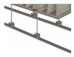
2- Encajar los aisladores en el perfil y deslizar los dispositivos de seguridad quedando ambos elementos acoplados. La distancia de descuelgue será de al menos 15 cm respecto del forjado.
