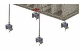
1- Previamente se habrá comprobado que el forjado no presenta huecos o fisuras, ya que en caso de existir se macizarán con mortero. A continuación, fijar las varillas roscadas al forjado e introducir los aisladores SE-47 G/M6DS a través de las varillas con sus correspondientes cazoletas. Para la suspensión del falso techo se utilizará una modulación de  $0,5 \times 1$  m. Si se han de suspender conductos de cualquier tipo se deberá recalcular el tipo de amortiguador y su modula-
