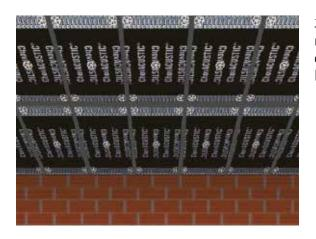
3- Los siguientes paneles se instalarán repitiendo el proceso anterior, hasta cubrir por completo la superficie y sin dejar ningún espacio entre ellos. Todas las juntas se sellarán con la cinta adhesiva **ELASTOBAND 70**, para asegurar la estanqueidad.
