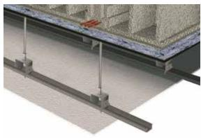
5- Atornillar la placa de yeso laminado de 15 mm a la estructura metálica y sellar las juntas entre ellas siguiendo las instrucciones de montaje de los sistemas de placa de yeso laminado.
