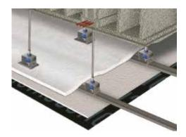
5- Adherir la lámina **ViscoLAM AUTOADHESIVA**, retirando previamente el plástico protector. Los diferentes tramos de lámina se colocarán a testa y contrapeando las juntas de la placa de yeso laminado.
