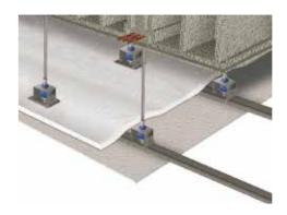
4- Extender sobre la estructura metálica y la placa de yeso laminado el absorbente acústico **ChovANAPA 4 cm PANEL 600.**
