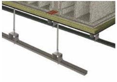
4- Fijar las varillas roscadas al forjado, introducir las piezas de cuelgue a través de las varillas y encajar ambos elementos de forma que queden acoplados. La distancia de descuelgue será de al menos 15 cm respecto del forjado.
