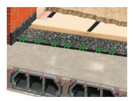
7- Por último, realizar la solera de mortero armada de espesor adecuado teniendo en cuenta la superficie del recinto y la carga de uso.
