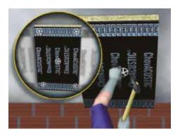
2- Introducir una espiga de fijación **ChovAFIX 8** con la ayuda de un martillo. Repetir este proceso realizando otros cuatro agujeros más, distribuidos como se muestra en el detalle de la figura.
