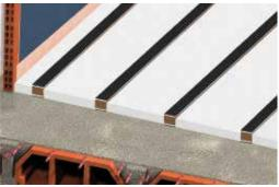
4- Insertar el material absorbente acústico de 40 mm fibra de poliéster ChovANAPA 4 cm PANEL 600 entre los rastreles. Se cubrirá toda la superficie sin dejar espacios entre paneles.
