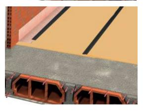
3- En los encuentros con tabiques y pilares instalar el material ChovAIMPACT BANDA para evitar la unión rígida entre solera y paramentos. Para facilitar la instalación utilizar la cinta adhesiva BANDA DE SOLAPE RT.
