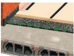
6- Instalar los siguientes tramos de material a testa hasta cubrir por completo la superficie. Sellar las juntas con cinta adhesiva, para asegurar la estanqueidad. En los encuentros con el perímetro instalar el material **ChovAIMPACT BANDA** para evitar que la lana mineral absorba el agua o humedad del mortero. Para facilitar la instalación utilizar la cinta adhesiva.
