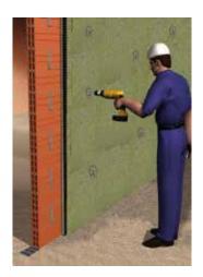
1-Previamente, debe comprobarse que el tabique no presenta huecos o fisuras, ya que en caso de existir, es conveniente rellenarlas con mortero. Cortar un tramo de ChovA-CUSTIC PLUS FIELTEX de longitud igual a la altura del tabique. Apoyar el ChovA-CUSTIC PLUS FIELTEX sobre el tabique.
