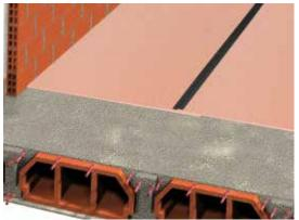
2- Instalar los siguientes tramos de material hasta cubrir por completo la superficie. En las láminas de 5 mm de espesor realizar en las juntas un solape de 10 cm. En las láminas de espesor de 10 mm no realizar solapes quedando la junta a testa.
