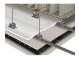
6- Atornillar la segunda capa de placas de yeso laminado de 13 mm a la estructura metálica y sellar las juntas entre ellas siguiendo las instrucciones de montaje de los sistemas de placa de yeso laminado. Las placas se colocarán contrapeando las juntas de la lámina ViscoLAM.
