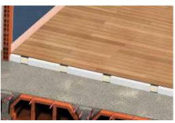
5- Fijar la tarima a los rastreles siguiendo las recomendaciones del fabricante. Por último, doblar la parte de la banda de polietileno en contacto con los tabiques sobre la tarima e instalar el rodapié.
