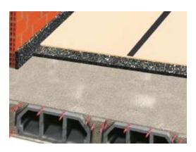
4- Insertar los siguientes tramos de material a testa hasta cubrir por completo la superficie. Sellar las juntas con cinta adhesiva, para asegurar la estanquidad.
