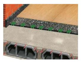
4- Cubrir toda la superficie con tableros de DM de 10 mm de espesor para garantizar el apoyo de la solera sobre los tacos de caucho. Los tableros se colocan a testa y no es necesario sellar las juntas.
