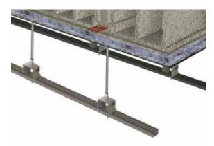
4- Fijar las varillas roscadas al forjado, introducir las piezas de cuelgue a través de las varillas y encajar ambos elementos de forma que queden acoplados. La distancia de descuelgue será de al menos 15 cm respecto del forjado.
