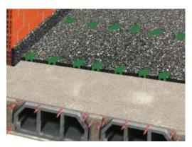
3- Distribuir los TACOS DE CAUCHO TS-80 (V150 ó R400) entre los paneles formando una retícula de forma que soporten la carga óptima para la cual están diseñados (150 ó 400 kg por unidad).
