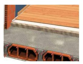
4- Por último, doblar la parte de la lámina en contacto con los tabiques sobre la madera e instalar el rodapié.
