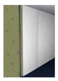
4- Atornillar la primera placa de yeso laminado a la estructura metálica siguiendo las instrucciones de montaje de los sistemas de placa de yeso laminado.
