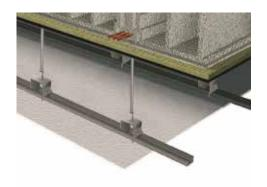
5- Atornillar la placa de yeso laminado de 13 mm a la estructura metálica y sellar las juntas entre ellas siguiendo las instrucciones de montaje de los sistemas de placa de yeso laminado.
