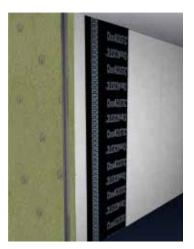
6. Atornillar la segunda capa de placas de yeso laminado de 13 mm a la estructura metálica y sellar las juntas entre ellas siguiendo las instrucciones de montaje de los sistemas de placa de yeso laminado. Las placas se colocarán contrapeando las juntas de la lámina ViscoLAM 65.
