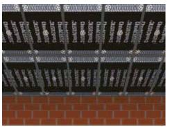
3- Los siguientes paneles se instalarán repitiendo el proceso anterior, hasta cubrir por completo la superficie y sin dejar ningún espacio entre ellos. Todas las juntas se sellarán con la cinta adhesiva **ELASTOBAND 50**, para asegurar la estanqueidad.
