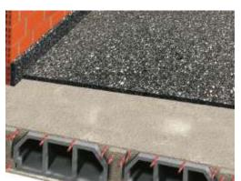
1- Previamente a la instalación del sistema se habrá comprobado que la superficie está limpia, seca y libre de irregularidades. A continuación, colocar en todos los encuentros con tabiques y pilares un perímetro de unos 15 cm de altura de **ChovAPREN 110/3** para evitar uniones rígidas con los paramentos.
