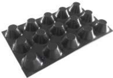
Membrana drenante nodular y retenedora de agua en polietileno de alta densidad (HDPE) específica para cubiertas ajardinadas, el agua se retiene en sus nódulos y la sobrante se elimina a través de los cortes de la zona superior.
