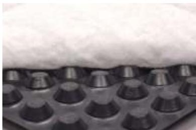
El geotextil incorporado actúa como filtro del agua, para impedir que la tierra acabe taponando el drenaje, mientras que los nódulos de polietileno (HDPE) conducen y evacúan el agua. El sistema completo funciona como drenaje del agua, y protección de la impermeabilización del muro, la cimentación, etc.
