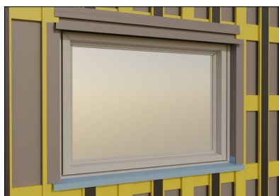
Der fuges mellem sålbænk og side inddækning.
