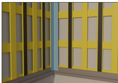
Blindfals BFSRP fastgøres med montage-skruer (V154) pr. 500 mm
