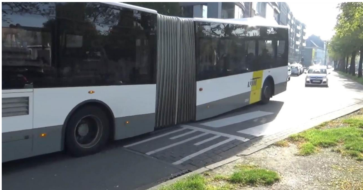
Foto 78: Vouwbalg tegen wegdek (Foto Bart De Mey)
