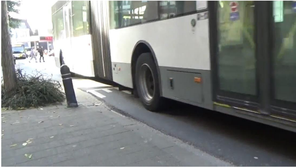
Foto 80: Vouwbalg tov correct aangelegd verkeersplateau (Foto Bart De Mey)
