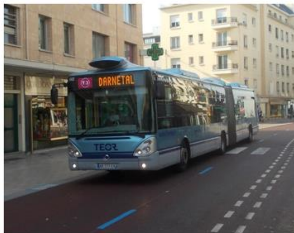
Foto 52 (a+b): HOV-systeem in Nîmes en Rouen, camera in midden op dak (foto's FDD)
