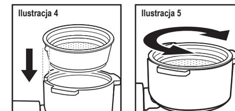
**UWAGA:** Aby wyjąć filtr w celu jego wyczyszczenia, obróć go w lewo lub w prawo, aby dopasować wypustkę filtra do otworu w kolbie, a następnie go wyjmij. **OSTRZEŻENIE:** Przed przystąpieniem do wyjęcia filtra z kolby upewnij się, że filtr się schłodził.
