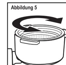
**HINWEIS:** Zum Entfernen des Filters für die Reinigung drehen Sie den Filter nach links oder rechts, um die Vertiefung des Filters auf die Aussparung des Siebträgers auszurichten, und entfernen Sie ihn.
