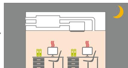
Bei abgeschalteter Lüftung und Klimaanlage steigt die Raumtemperatur, weil die Wände sich tagsüber aufgeheizt haben.
