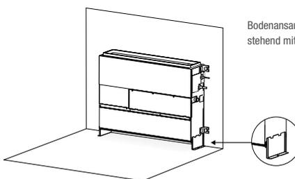
Bodenansaugung/Montage auf dem Boden stehend mit Füßen.
