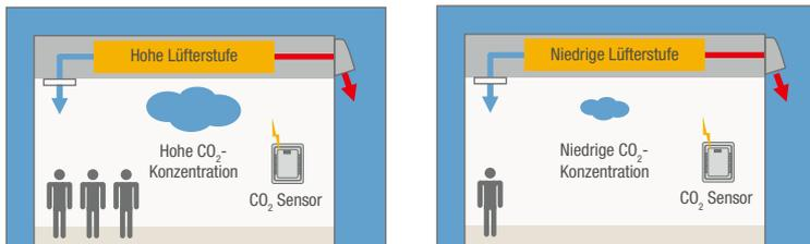
Die Lossnay-Geräte der Serien LGH-RVX(T) und LGF-100GX verfügen standardmäßig über einen Anschluss für einen baauseitigen CO<sub>2</sub>-Sensor.
