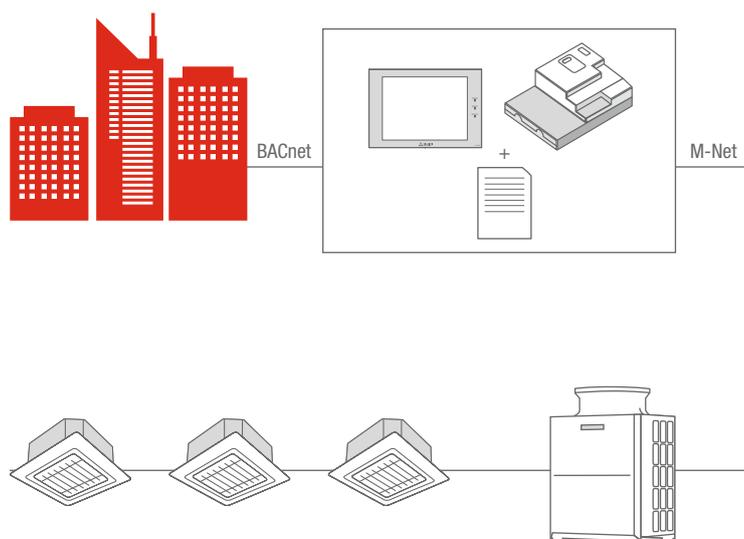
Dieses Paket ermöglicht die Einbindung der Klimasysteme an eine BACnet Gebäudeleittechnik-Systeme.
