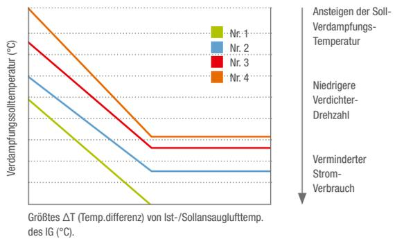
1 Die Einstellung der Verdampfungstemperatur muss über die DIP-Schalter am Außengerät vorgenommen werden.
