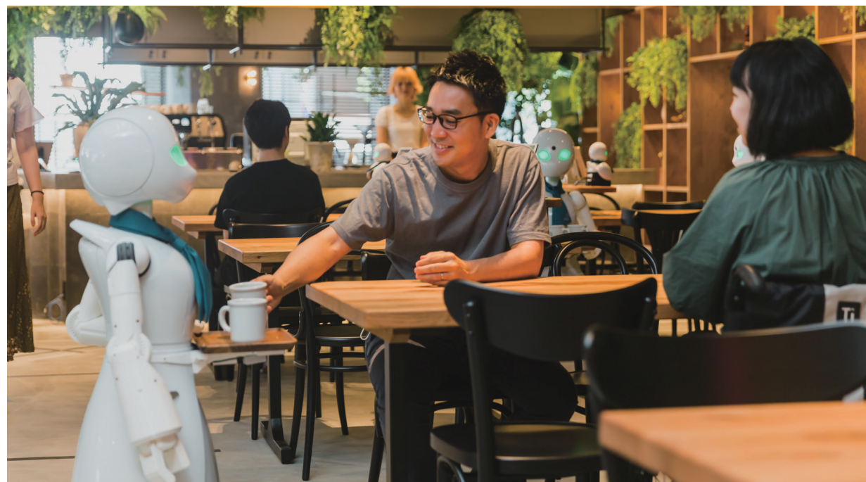
「分身ロボットカフェDAWN ver.β」で接客をおこなう「OriHime-D」。一見したところAIに見えるが、生身の人間が操縦している
