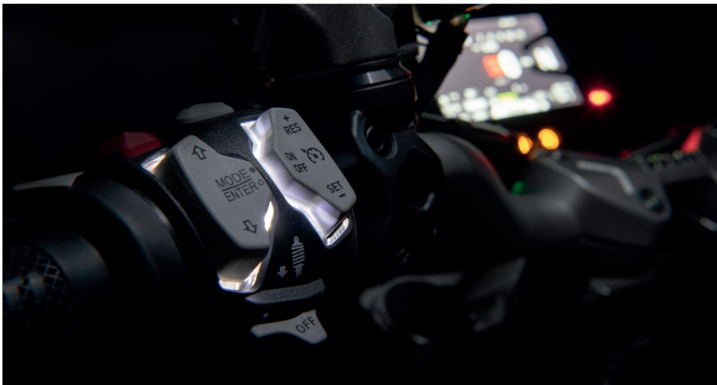
Le système VHC (Vehicle Hold Control) assiste le pilote dans les démarrages en côte. Cette fonction s'active lorsque ce dernier exerce une pression importante sur le frein avant ou arrière alors que la moto est à l'arrêt et la béquille centrale relevée. À cet instant, le système électronique immobilise la Multistrada V2 en agissant sur le frein arrière. Restez à l'aise mais restez connecté.
