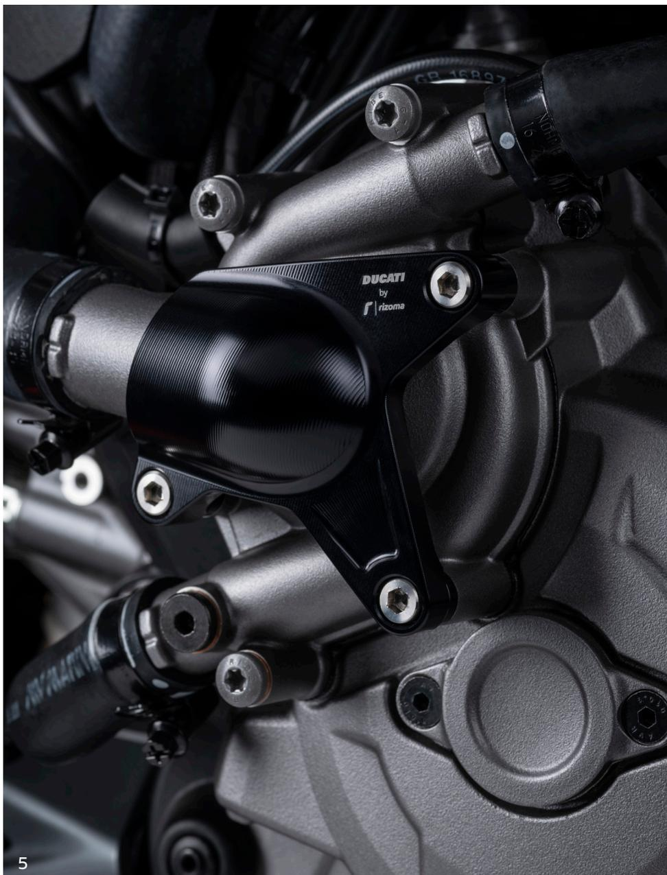
5\_ Couvercle de pompe à eau aluminium taillé dans la masse **A** ■
