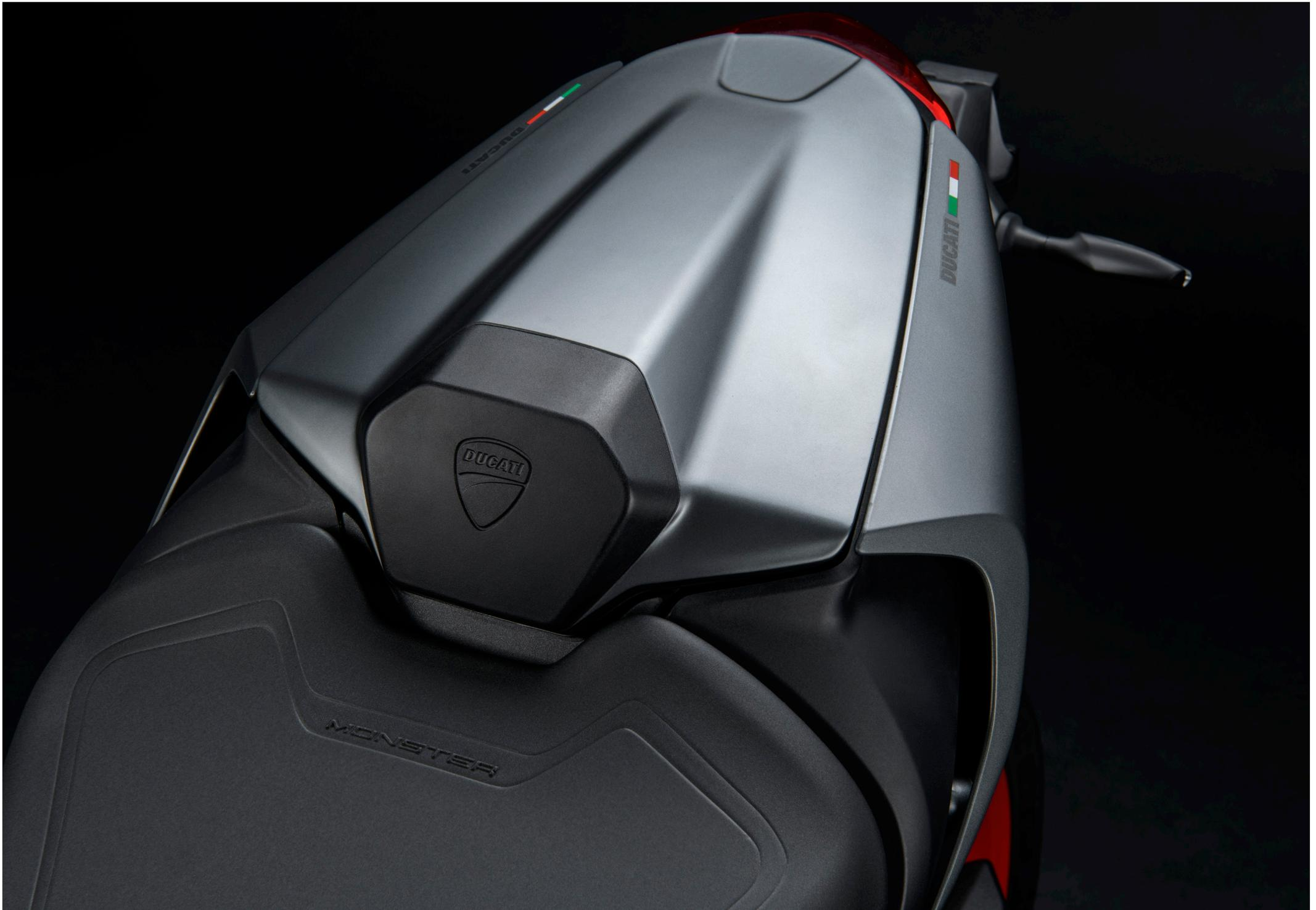
La boucle arrière courte, épurée, sinieuse et sculpturale à la fois, comporte : un cadre arrière en polymère renforcé aux fibres de verre, aussi structurel qu'esthétique puisqu'il est apparent, et deux panneaux latéraux peints.
