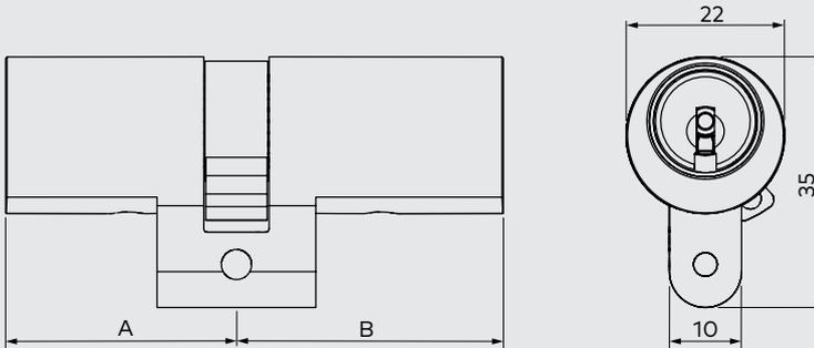
Doppelzylinder-Rundprofil 22 mm
