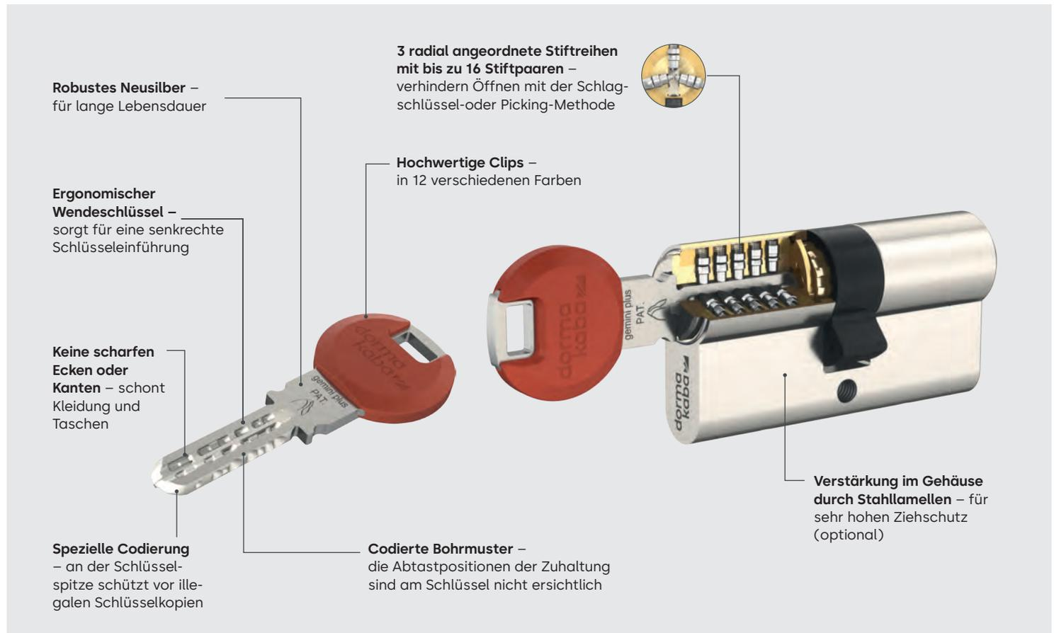
**gemini plus ist ein patentiertes Wendeschlüsselsystem und besonders für kleinere bis mittlere Schließanlagen geeignet.**
