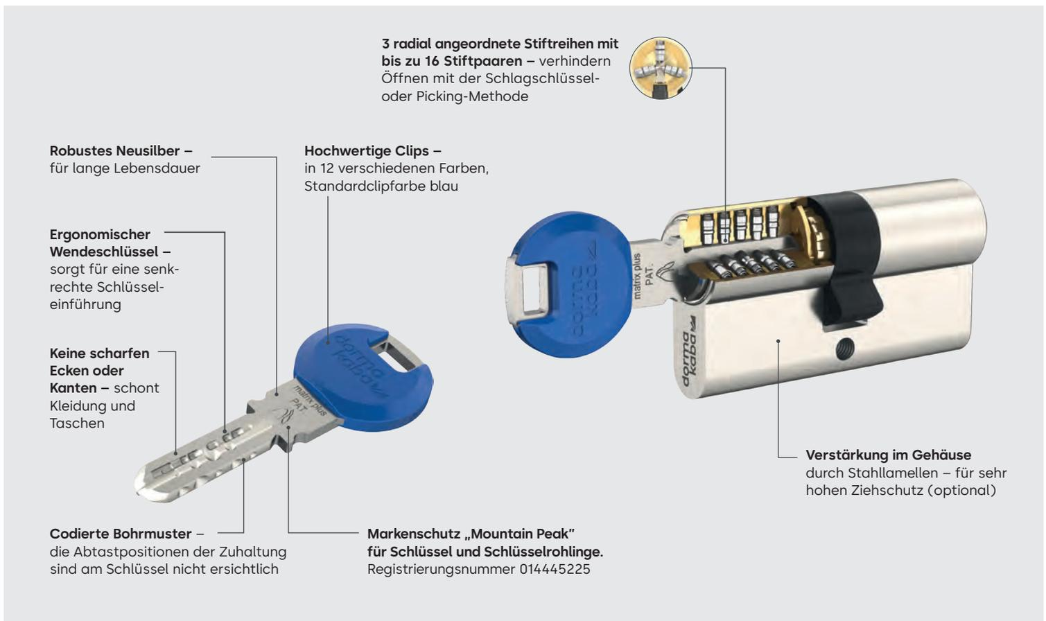
**matrix plus ist ein patentiertes Wendeschlüsselsystem, das vor allem in Haus- und Wohnungseingangstüren eingesetzt werden kann.**
