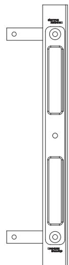
Die Montageplatte sorgt für eine weitere Verbindung zwischen Schließblech und Türstock/Zarge und gewährleistet dem Schließblech zusätzlichen Halt.
