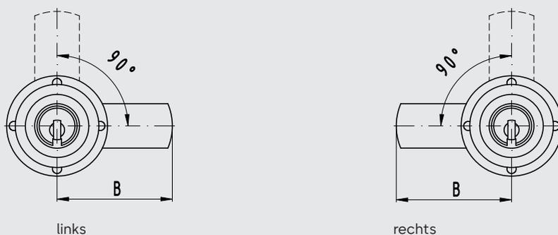
**Riegel rechts und links verwendbar**
