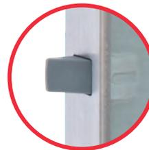
↳ Durch die am Stulp angebrachte Hilfsfalle wird beim Schließen der Tür die Schlossfalle automatisch blockiert. In Verbindung mit einem dormakaba c-lever oder Wechselbeschlag ist die Tür dadurch automatisch ohne Schlüsselbetätigung versperrt.
