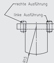
Die Verschlussriegel 1061-601 und 1061-601A/B/C/D sind links und rechts verwendbar.
