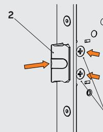
1. Die beiden Senkkopfschrauben (1) lösen und Falle (2) herausdrehen
