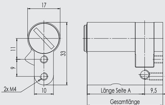
Halbzylinder als Schalterzylinder
