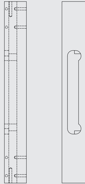
Eine zusätzliche türstockseitige Verschraubung mit 2 Halbrundkopfschrauben ist mit den Schließblechen SB/VAR und SB/VAR.7 möglich.
