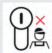
Schlüsselkanal in der normalen Stellung: 6 Uhr
