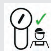
Schlüsselkanal in der Service-Position: 8 Uhr
