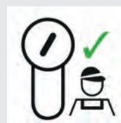
Schlüsselkanal in der Service-Position: 8 Uhr
