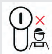
Schlüsselkanal in der normalen Stellung: 6 Uhr
