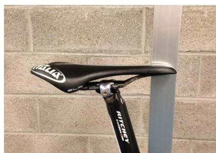
Le bec de cette selle passe exactement par la verticale passant par l'axe de la boîte de pédalier. Il est interdit de dépasser cette limite, quelles que soient les circonstances.
