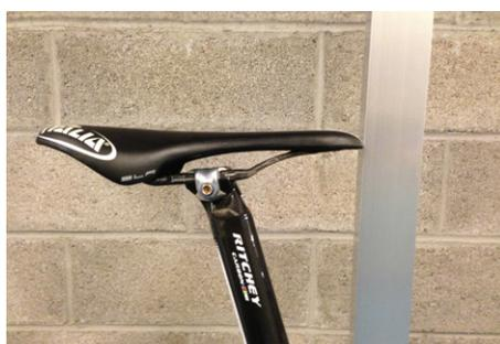
Cette selle est en retrait de 5 cm par rapport à la verticale passant par l'axe de la boîte de pédalier. Cette position est conforme et ne nécessite pas de test morphologique.
