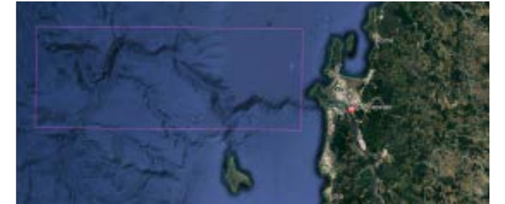
1. Cuenca de la desembocadura del río Biobío, vista desde Google Earth, utilizada para extraer las curvas de relieve con las que se generó el modelo 3D de la misma.
