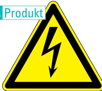
W012 Warnung vor elektrischer Spannung; ASR A1.3, DIN EN ISO 7010
