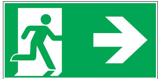
E002 Notausgang rechts, Richtungspfeil; ASR A1.3, DIN EN ISO 7010
