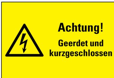
W012 Warnung vor elektrischer Spannung; Achtung! Geerdet und kurzgeschlossen; ASR A1.3, DIN EN ISO 7010
