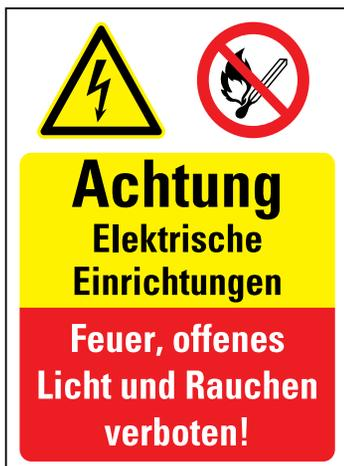
P003 Keine offene Flamme, Feuer, offene Zündquelle und Rauchen verboten, W012 Warnung vor elektrischer Spannung; Achtung Elektrische Einrichtungen
