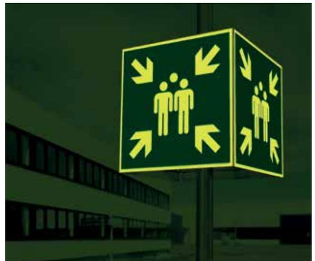
**Gemäß ASR A1.3 und ASR A2.3 sollten Sammelstellen für eine zielgerichtete Personenlenkung dauerhaft und deutlich gekennzeichnet sein.**
