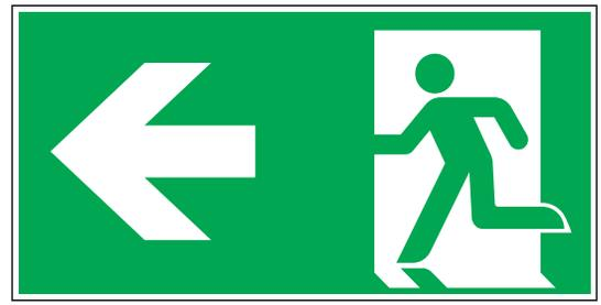
E001 Notausgang links, Richtungspfeil, links; ASR A1.3, DIN EN ISO 7010
