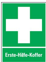
E003 Erste Hilfe; Erste-Hilfe-Koffer; ASR A1.3, DIN EN ISO 7010
