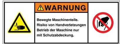
P015 Hineinfassen verboten, W024 Warnung vor Handverletzungen; Warnung; Bewegte Maschinenteile. Risiko von Handverletzungen Betrieb der Maschine nur mit Schutzabdeckung.
