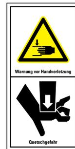
Crushing of fingers or hand - Force applied from above, W024 Warnung vor Handverletzungen; Warnung vor Handverletzung Quetschgefahr;
