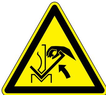
W031 Warnung vor Quetschgefahr der Hand zwischen Presse und Werkstück; DIN EN ISO 7010
