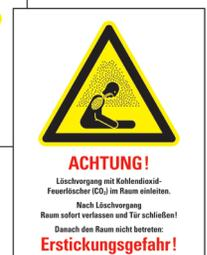
W041 Warnung vor Erstickungsgefahr; Achtung! Löschvorgang mit Kohlendioxid-Feuerlöscher (CO<sub>2</sub>) im Raum einleiten. Nach Löschvorgang Raum sofort verlassen und Tür schließen! Danach den Raum nicht betreten: Erstickungsgefahr!
