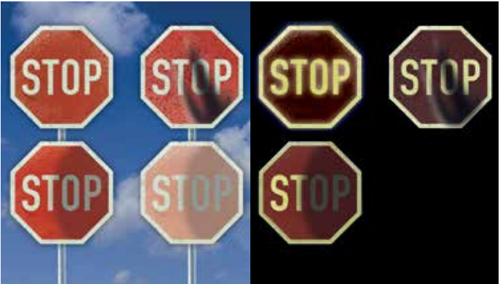
Tag-Nacht-Vergleich: Darstellung verschiedener Verkehrsschild-Zustände (verschmutzt, beschädigt, verformt, ausgebleicht), die zu einer Beeinträchtigung bis hin zum vollständigen Verlust der Reflexionseigenschaft föhren.
