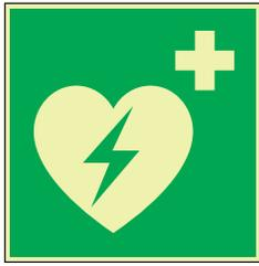
E010 Automatisierter externer Defibrillator; ASR A1.3, DIN 67510, DIN EN ISO 7010
