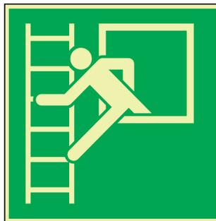
E016 Notausstieg mit Fluchleiter; ASR A1.3, ASR A2.3, DIN 67510, DIN EN ISO 7010
