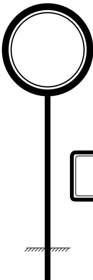
**Rohrrahmen zum Einbetonieren für: runde Schilder mit einem Ø von 600 mm**
