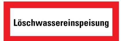
Löschwassereinspeisung; DIN 4066
