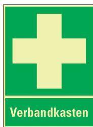
E003 Erste Hilfe; Verbandkasten; ASR A1.3, DIN 67510, DIN EN ISO 7010
