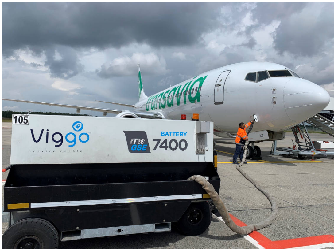
► Een elektrische Ground Power Unit ter vervanging van een dieselgedreven aggegraat.
