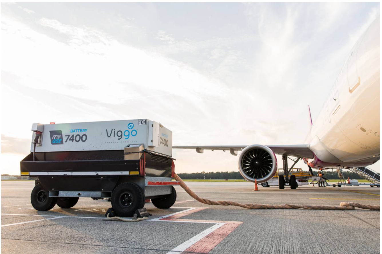
► Elektrische Ground Power Unit als alternatief voor dieselaggregaten
