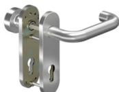
Ручки на длинной планке 7051K PZ/72 и с knobом 3020. Шток ручек: 8 мм, толщина двери: 38-56 мм. Накладка для использования с цилиндрами DIN стандарта
