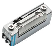
Basic-XS Электрозащелка компактного дизайна для терморазделенных профилей с регулируемым радиусным язычком для дверей с притвором и без, симметричная, нормально-закрытая. Размеры: 16 x 66 x 25,5 мм. -E-функция механической разблокировки.
