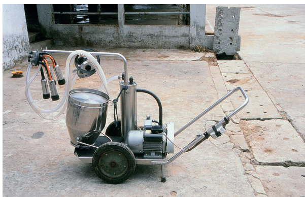
Автономный доильный аппарат с электромотором для доения заражённой коровы во избежание попадания её молока в общее хранилище.
