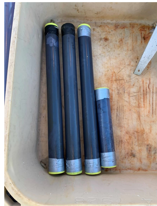
Mynd 4-2 Borað var niður í hafsbotninn og setkjarnar teknir upp í 5 m langa plasthólka. Hver hólkur var sagaður niður í 1 m langa hluta, þeir merktir og staflað í fiskikör.
