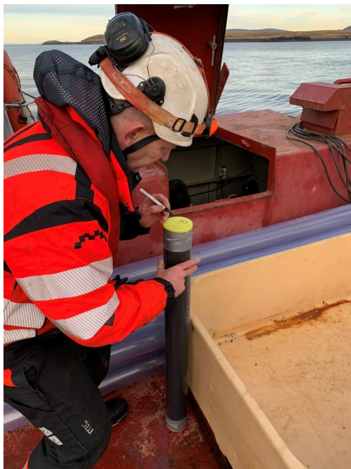
Mynd 4-2 Borað var niður í hafsbotninn og setkjarnar teknir upp í 5 m langa plasthólka. Hver hólkur var sagaður niður í 1 m langa hluta, þeir merktir og staflað í fiskikör.
