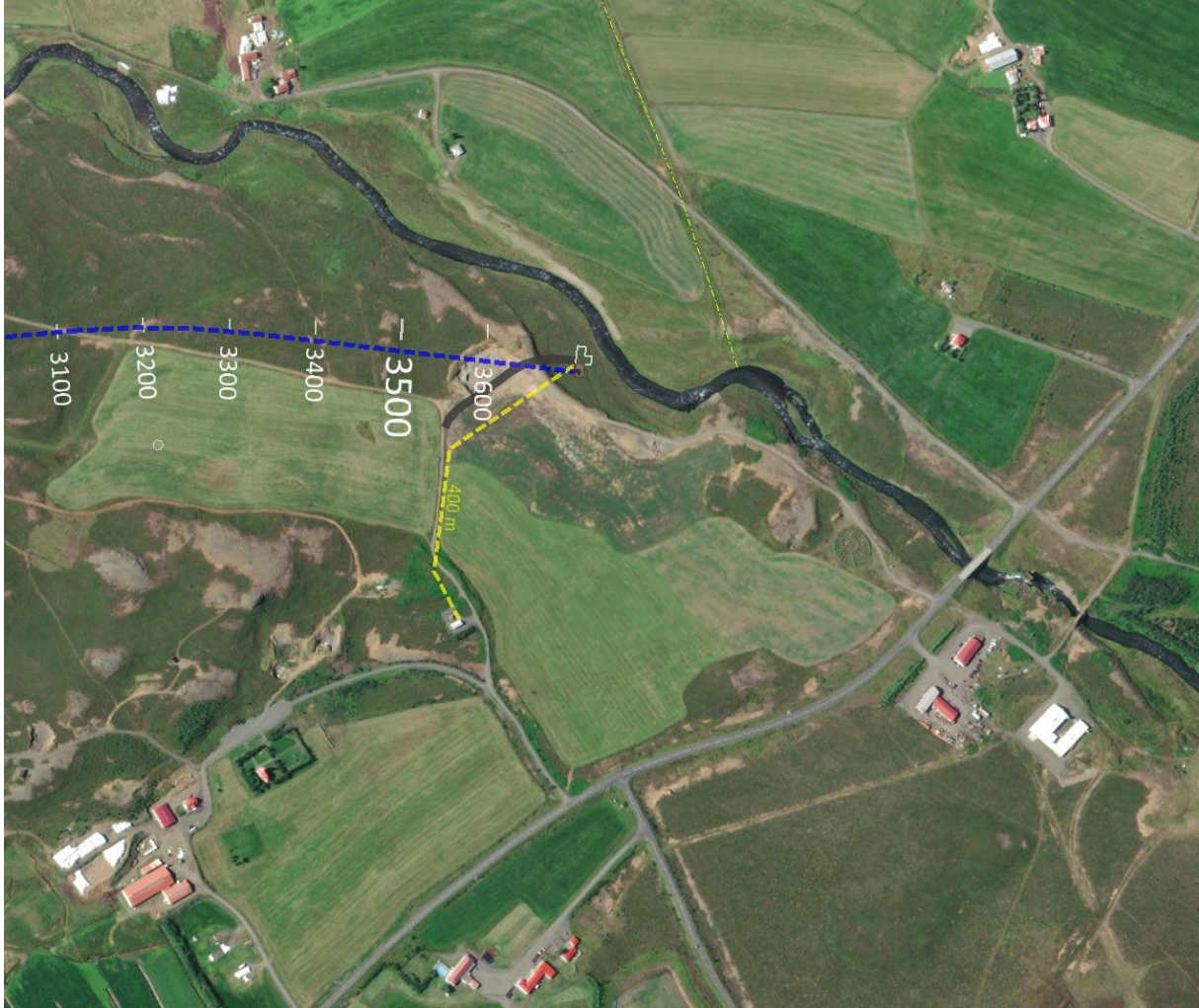
MYND 2.19 Fyrirhuguð tenging frá stöðvarhúsi að spennistöð Rarík (gul strikalína).
