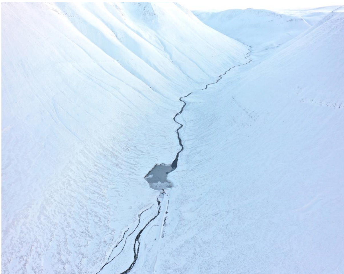
MYND 4.29 Raunaðstæður við Hólsvirkjun á Norðurlandi að vetri til er allt rennsli árinna fer í aðrennslispípu og ekkert rennur um yfirfall. Mjög fljótlega bætast við lindir og lækir sem viðhalda rennsli og vatni í farveginum. Mynd: Skírniir Sigurbjörnsson.
