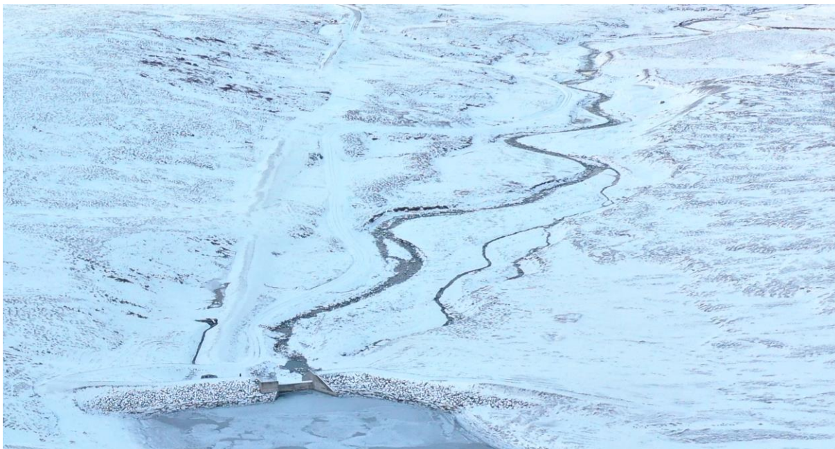
MYND 4.30 Raunaðstæður við Hólsvirkjun á Norðurlandi að vetri til er rennsli árinna fer allt í aðrennslistípu og ekkert rennur um yfirfall. Horft niður eftir farveginum sem fljótt fær vatn úr lækjum og lindum. Mynd: Skírnir Sigurbjörnsson.
