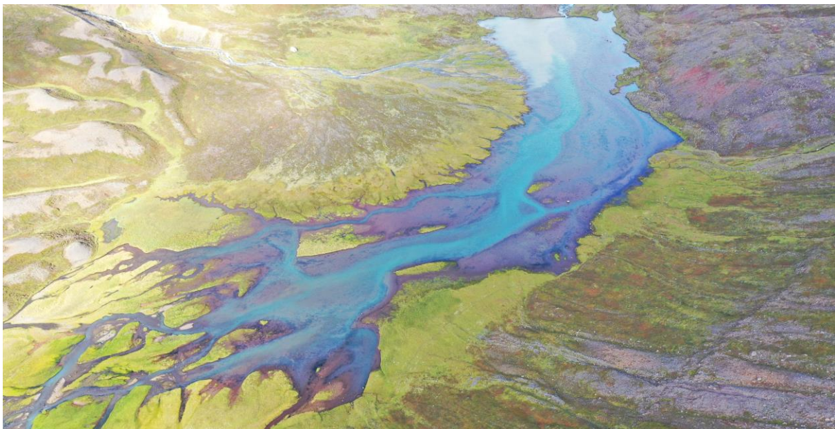
MYND 4.41 Loftmynd af núverandi lóni í Þorvaldsdalsá. Ekki ber á mól, áreyrum eða öðrum framburði eftir 30 ár.
