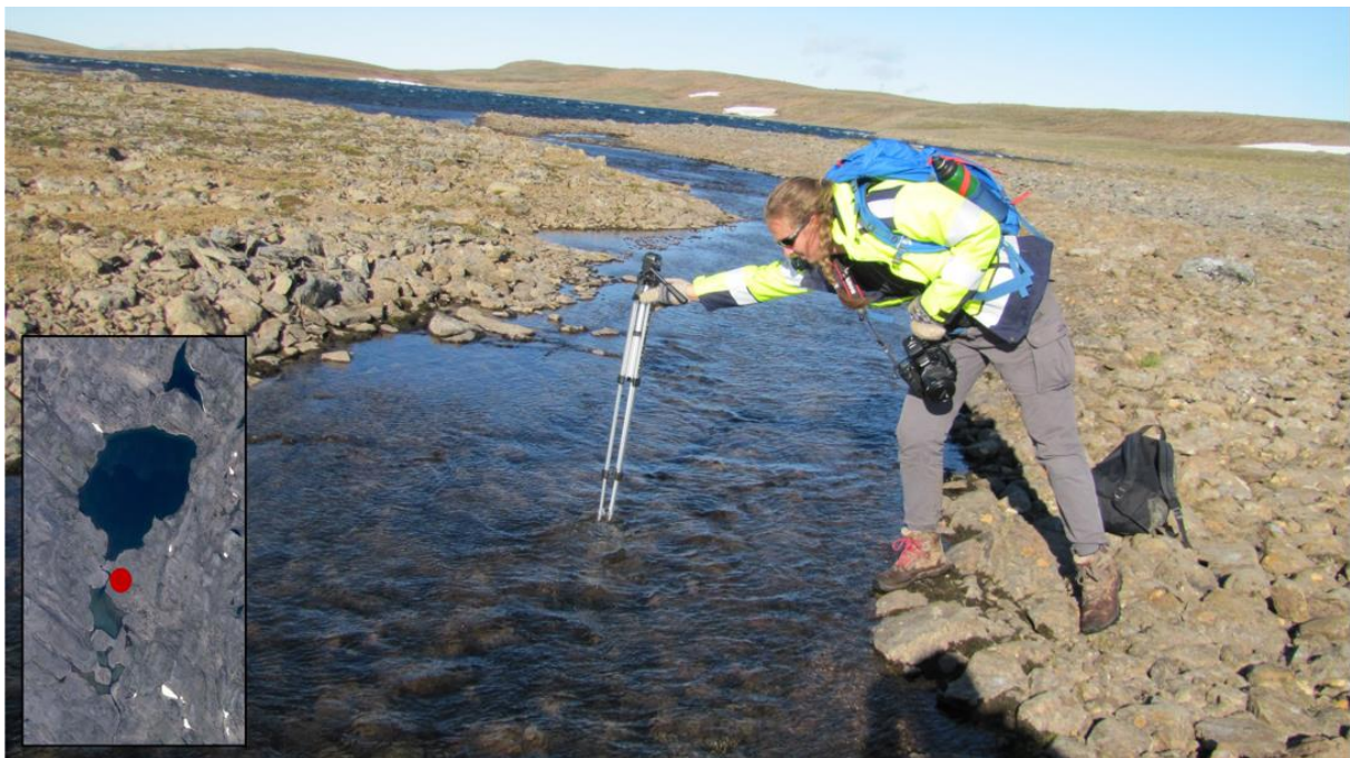
Mynd 6-6 Afrennsli Svartagilsvatns. Reiknað er með að grafa um 2 m djúpan skurð á þessum stað til að lækka náttúrulegt vatnsborðið vatnsins.
