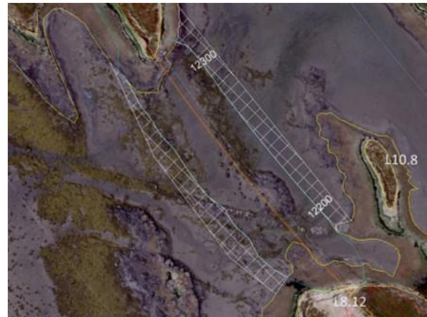
Mynd 13. Dæmi um hvar væri hægt að setja niður sjávarfitjungsvist utan á vegfyllingu við sjó (hvítrúðustrikað svæði).
