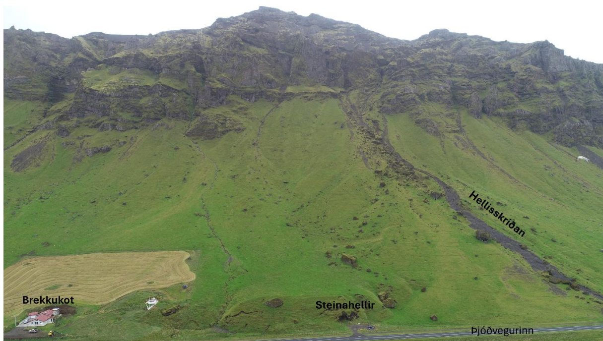
Mynd 7. Svæði í kringum Steinafjalli er augljóslega í hættu vegna grjóthruns. Stórir hnullungar liggja í brekkunni og má reikna með að þeir séu eftir grjóthrun árin 1979, 1984 og 1986.
