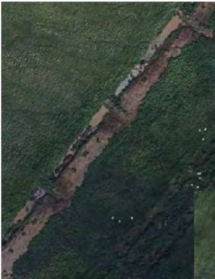
Mynd 12. Hér hafa ruðningar ekki dugað til að fylla skurðinn og hann því hálfylltur með þverböndum á milli
