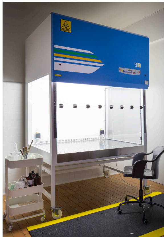
Útsogsskápur kemur í veg fyrir að skaðleg efni fari út í andrúmsloftið.
