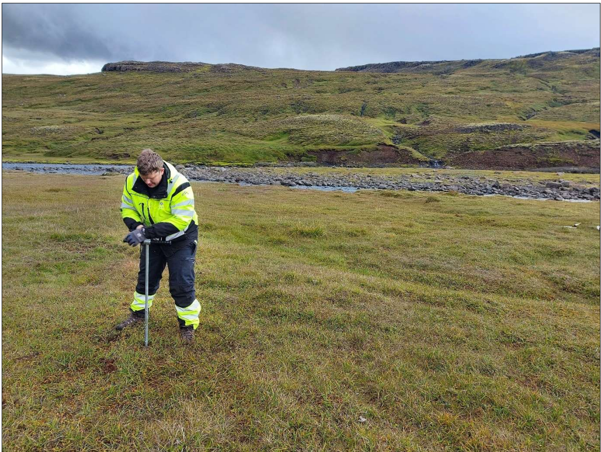
Mynd 3.16 Könnun á þykkt lífræns efnis ofan á ármalarefni, um 20 m frá Geitdalsá í fyrirhugaðri námu H.
