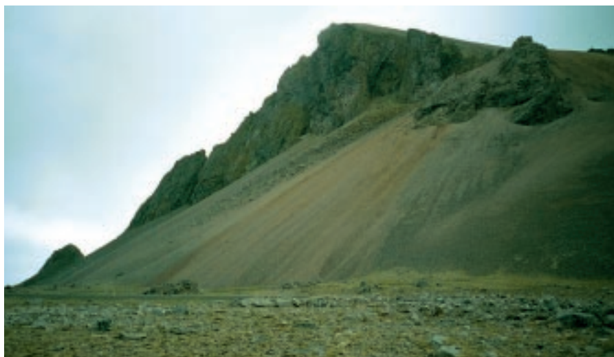
Mynd 6.11: Dæmi um lagfæringu: Efnistaka úr námu í Hvalnesskriðum. Lögun blíðarinnar er baldið eins og kostur er við efnistöku.
