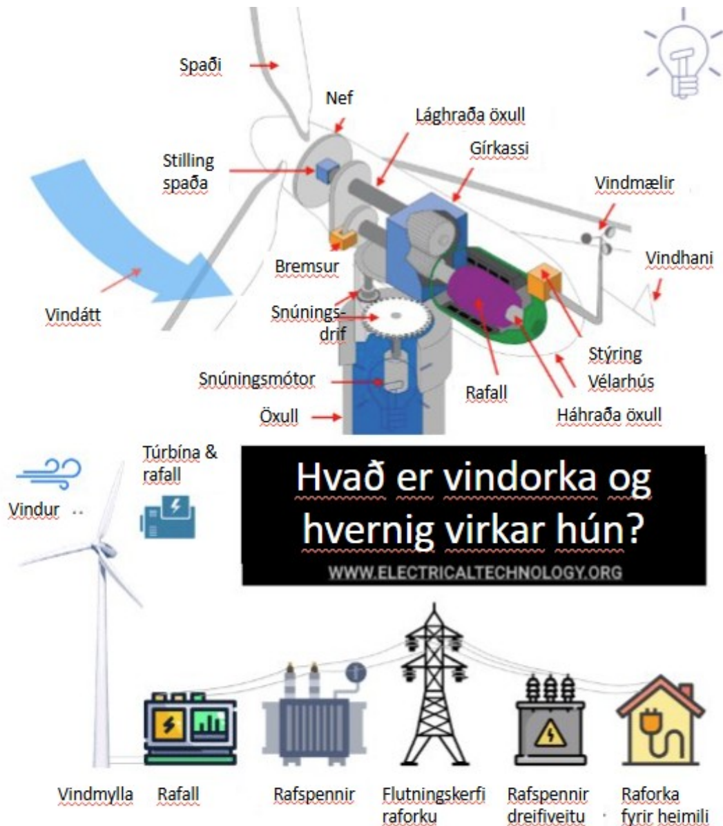
Mynd 24 Skýringarmynd vindmyllu og tengingar framleiðslu við notendur.
