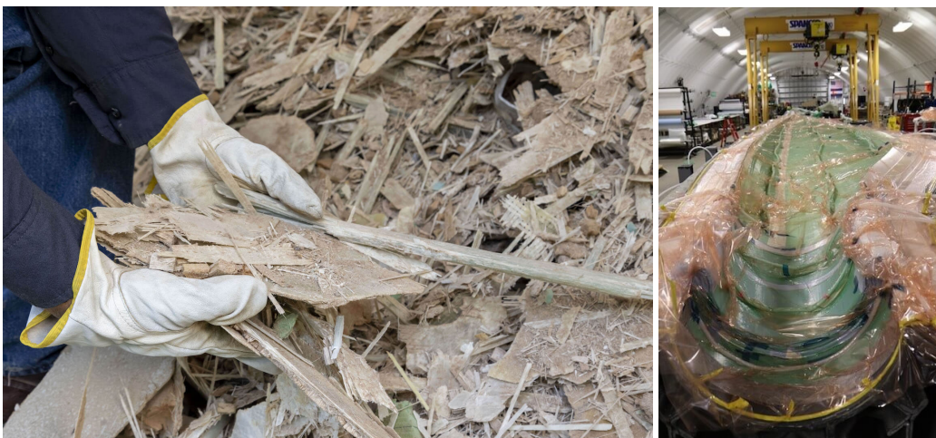
Mynd 30 T.v. Framleiðsla á spaða sem hægt verður að endurvinna að líftíma loknum. (Mynd Ryan Beach, NREL 62034). T.h. Endurvinnsluferli vindmylluspaða lokið hjá Veolia. (Mynd Veolia)
