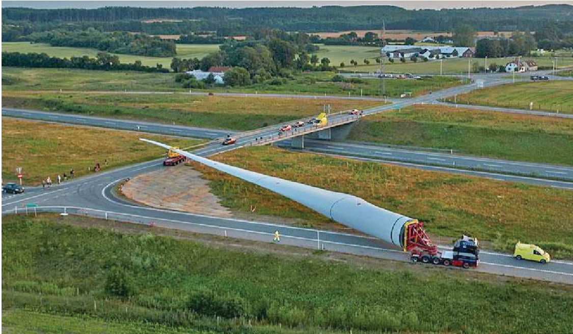
Mynd 15 Flutningur á vindmylluspaða. Sjá má hvernig 90 gráðu beygjan er leyst með uppfyllingu.
