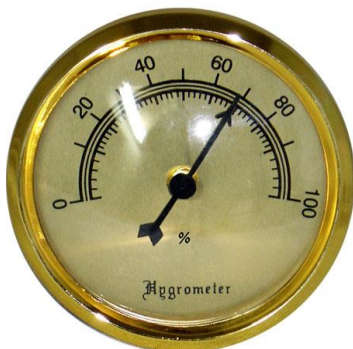
Mynd 10: Einfaldur rakamælir. Af honum þarf að lesa daglega og skrá upplýsingarnar handvirkt. Mynd 11: Ódýr rakavísir úr pappír sem er mjög gagnlegur í sýningarskápum eða í gegnsæjum plastkössum í geymslum.
