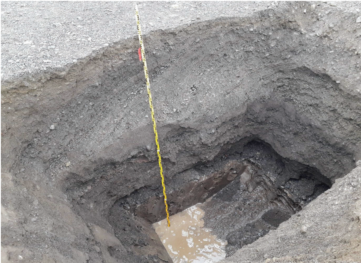
Mynd 12: Gryfja nr.1 í námunni í Garpsdalsmelum. Siltlag á 2,5 m dýpi sem gæti skert vinnsludýpið í námunni. Um útbreiðslu lagsins er ekki vitað.
