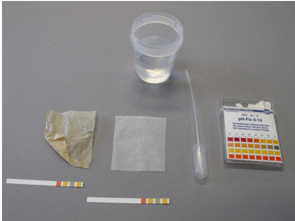
Mynd 96: Áhöld og efni sem þarf við mælingu á sýrustigi pappírs. Tveir pappírþútar sem mæla á og pH-strimlar neðan við, afjónað vatn, dropateljari og kassinn utan um strimlana, sem segir til um pH-gildi. Mynd 97: Pappírþútar eru bleyttir í afjónuðu vatni, og pH-strimlarnir settir ofan á þá með fargi (hér glerplötum).
