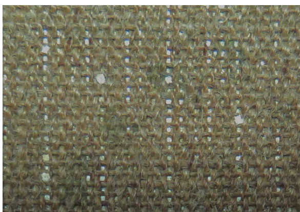
Mynd 32: Strigi sem hefur slaknað á þegar grunnur var borinn á. Grunnurinn hefur lekið í gegnum strigann eins og sést vel á bakhliðinni. Verkið er því viðkvæmara fyrir rakabreytingum en ella. Mynd 33: Bakhlið málverks með samansaumað léreft. Saumurinn hefur áhrif á málningarlagið og sést yfirleitt greinilega á framhlið verka.
