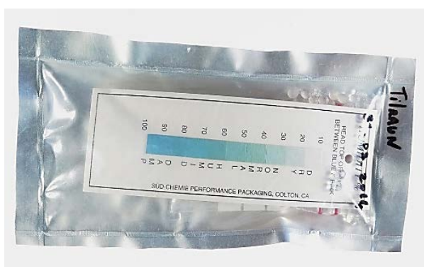
Mynd 91: Ageless Eye™. Mynd 92: Rakastrimill® gefur vísbendingar um rakastig í pokanum.
