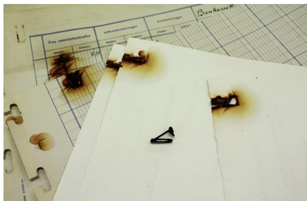
Mynd 30: För eftir ryðgaðar bréfastemmur. Ryð smitast einnig út frá heftum.
