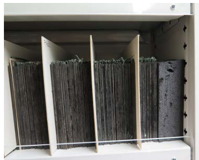
Myndir 63, 64, 65: Ráðlögð aðferð við að geyma glerplötunegatífur og glerskyggjur.
