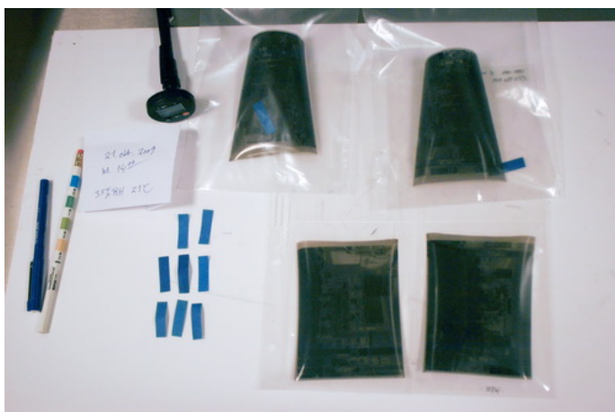
Mynd 45: Könnun á ástandi díasetatfilma með A-D sýrustigsprófum (e. A-D Strips ). Þau sýna stig hrörnunar vegna „ Vinegar Syndrome “, þ.e. hvort filmurnar séu farnar að skemmast.
