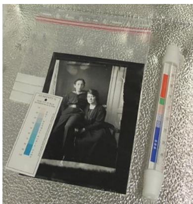
Mynd 96: Rakamæli og rakastrimill í frystikistu.
