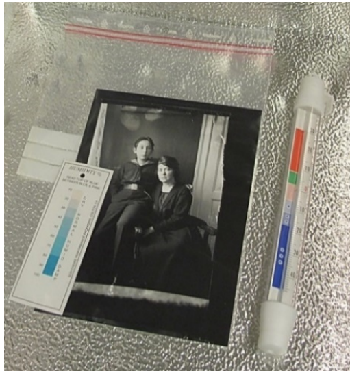
Mynd 83: Rakamælistrimlum komið fyrir í pokanum með myndinni til að fylgjast sem best með rakastigi.
