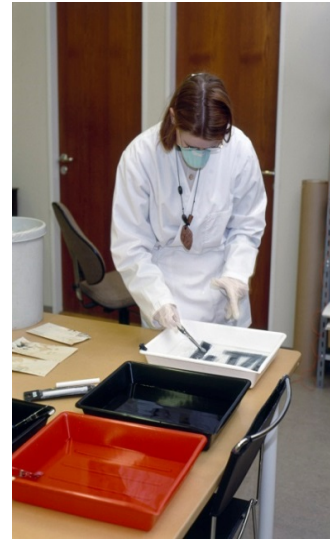
Myndir 91, 92: Dæmi um mynd sem farin er að mygla vegna raka. Hreinsun á mygluðum filmum (negatífum). Þær eru m.a. hreinsaðar í alkóhóllausn.
