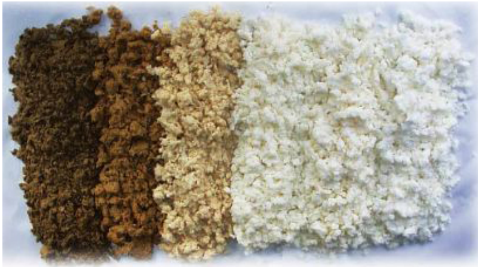
Mynd 3: Hreinsun trjámauks. Dökki liturinn í trjámaukinu er að mestu leyti af völdum afgangstrénis. Hann minnkar stig frá stigi meðan á hreinsuninni stendur.
