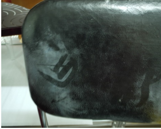
Mynd 62: Mygla á stól úr leðri. Mynd 63: Bakhlið málverks: Mygla í lífrænu lími í striga.
