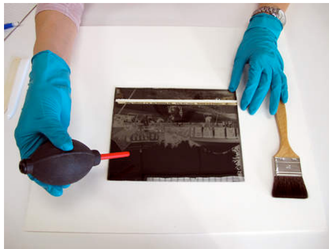
Mynd 93: Mynd hreinsuð með lofti úr litlum belg. Aðferðinni ber að beita einungis á glerplötur og filmur sem eru í mjög góðu ástandi (yfirborðið flagnar ekki).
