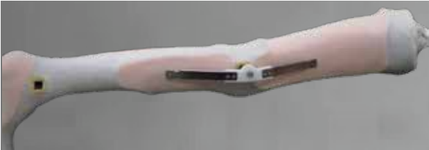
関節軸にあたる部分に角材 を使用しているので、回転 せず支柱の平行も見やす くなります。また足関節と膝 関節の平行も出しやすくな ります。
