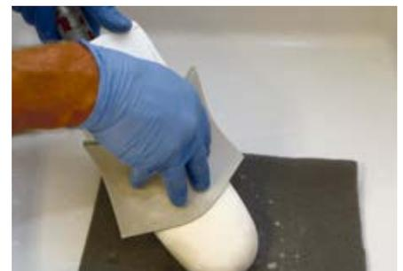
Erneut Soft Pad Schleifpapier mit Wasser vollsaugen lassen und mit der Schaumseite das Gipsmodell abziehen, um mit den entstandenen Gipsrückständen feine Poren zu schließen.
