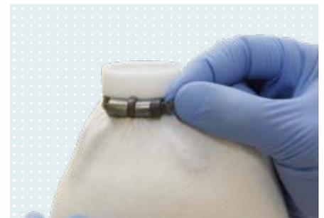
Die entsprechenden Bereiche der einzulaminierenden Gegenstände mit dem vorgeformten Plastaband isolieren (z. B. Schraubenköpfe, freiliegende Gewindgänge, Gelenkflächen).
