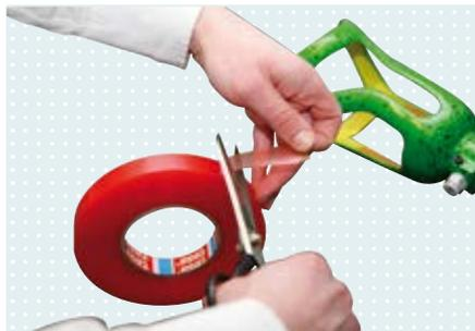
Zu verklebende Stellen (hier: Innenschaft und Rahmen) mit Isopropylalkohol 634A58 reinigen. Doppelseitiges Klebeband 633D5 auf gewünschte Länge zuschneiden.
