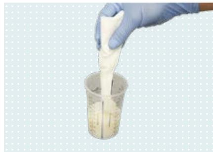
Den mit Gipsstrennflüssigkeit imprägnierten Trikot-schlauch aus der Flasche bzw. dem Messbecher nehmen und direkt über das Modell ziehen.
