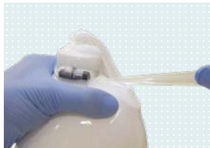
Polyethylen-Klebeband 627B40 um die nach dem Laminieren zu öffnenden Bereiche kleben und dabei mit dem vorgespannten Klebeband das überschüssige Harz in diesen Bereichen zu reduzieren. Das Klebeband kann unter Vorspannung zu einer Kordel gedreht werden, um den Harzüberschuss auch an schwer zugänglichen Stellen zu reduzieren.
