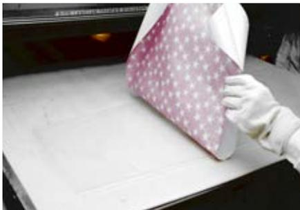
Erwärmen Sie das Kunststoffmaterial bis es vollkommen transparent geworden ist. Legen Sie das zugeschnittene Thermo-papier mit dem Design nach unten auf den Zuschnitt.
