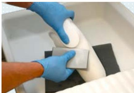
Mit dem vollgesogenen Soft Pad Schleifpapier das Gipsmodell mit kreisenden Bewegungen unter geringem Druck mit der Kornoberfläche bearbeiten. (Die Schleifrückstände nicht unter fließendem Wasser abspülen!) Soft Pad Schleifpapier kann mittig gefaltet werden, um kleine Radien zu bearbeiten ohne den Randverlauf zu beschädigen.
