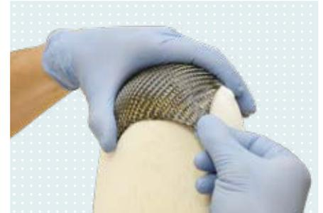
Carbonfaserzuschnitt auf die zu verstärkenden Stellen der Armierung positionieren und diesen dabei in die Faserrichtungen vorspannen.
