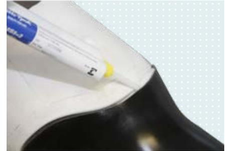
Pastasil Dummy entfernen, Aussparung freischneiden und Schafttrand beschleifen. Schaft auf dem Gipsmodell oder Abformer positionieren. Die entstandene Tasche mit BetaSil 616S5 von distal nach proximal auffüllen, dabei den Statikmischer bei Beginn bis ans untere Ende der Tasche einführen. Nach Vulkanisation der BetaSil-Einlage, diese beschleifen und an vorgesehener Stelle im Schaft positionieren.
