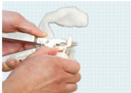
Mit einem Feuerzeug die Schnittfläche verschweißen und unmittelbar darauf die Schweißnaht glätten.
