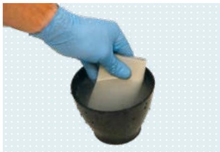
Soft Pad Schleifpapier 649G26 zusammengedrückt ins Wasser tauchen und vollsaugen lassen.
