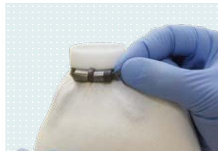
Die entsprechenden Bereiche der einzulaminierenden Gegenstände mit dem vorgeformten Plastaband isolieren (z. B. Schraubenköpfe, freiliegende Gewindgänge, Gelenkflächen).
