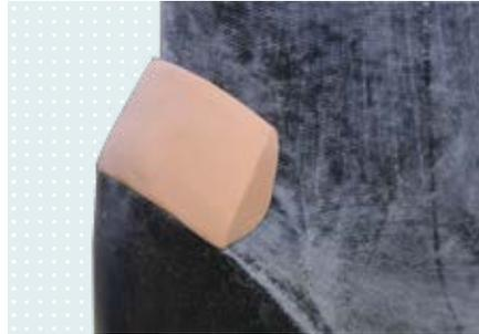
Dummy aus Pastasil 85H11 an vorgesehener Stelle auftragen. Nach Aushärtung zuschneiden, zuschleifen und von außen aufrauen. Ersten Guss ebenfalls aufrauen und mit Isopropylalkohol 634A58 reinigen. Pastasil Dummy platzieren und in gewohnter Weise armieren und überlaminieren.
