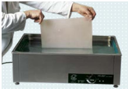
Materialzuschnitt aus ThermoLyn Pedilon in ca. 60 °C warmes Wasser der Wasserpfanne 759P1=220 legen. Das Material wird bei Erreichen der Umformungstemperatur transparent. Jetzt Zuschnitt mit einem Holzspatel entnehmen und Wasser abtropfen lassen.
