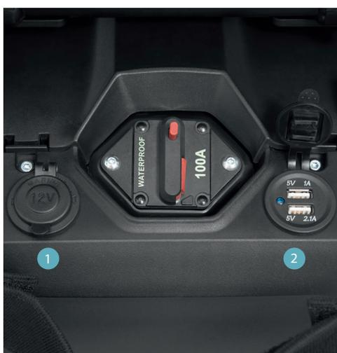
► Conexión 12/24 V (1), puerto de carga USB (2)
