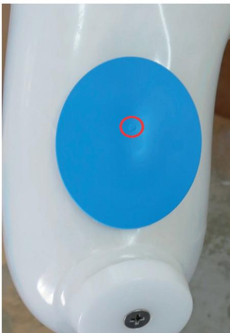
ダミー外側の電極ボリューム用の突起(赤丸部)が、近位になるように置きます。
