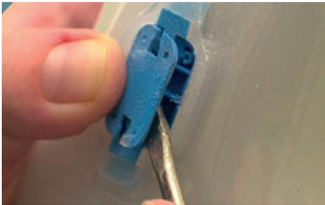
ダミーの外側を均等に削り落としたら、ダミーキャップ①を外します。
