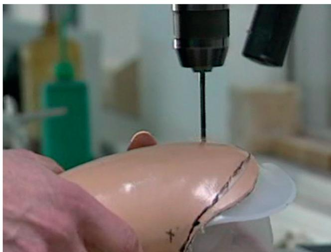
内ソケットと支持部を固定するために、4mmのネジ穴を3～4か所あけます。
