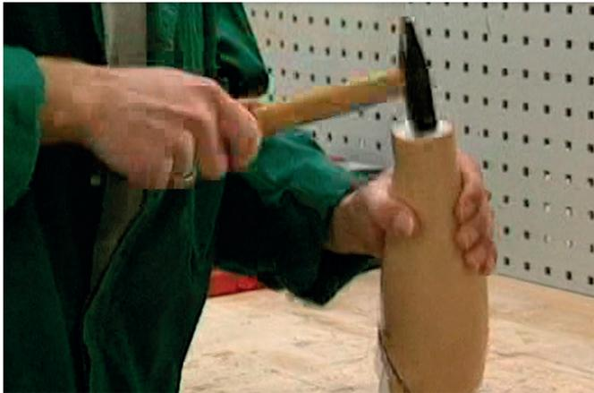
遠位部に取り付けた、リストダミーをハンマー等でたたき取外します。
