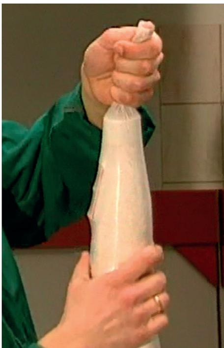
薄いストッキングを1枚と、PVAバッグを被せ上下を縛り吸引します。
