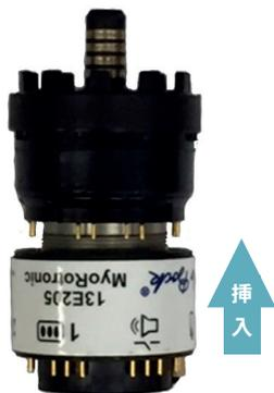
コントロール部をローテーターに挿入します。
