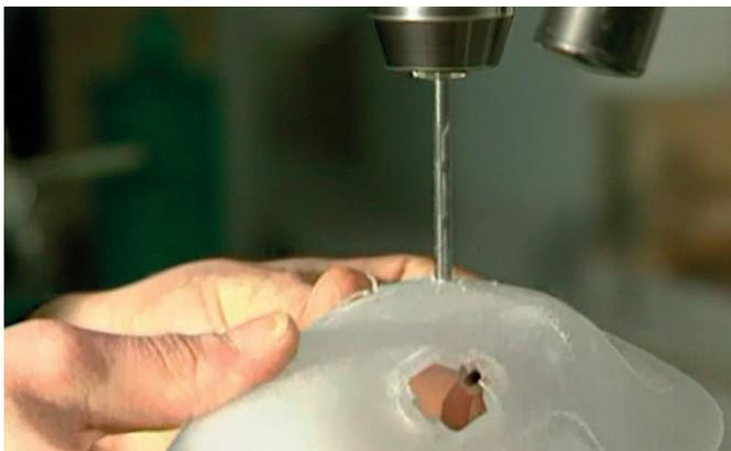
「6-6. ラミネーション後処理」で開けた外ソケットとの固定用の穴を、内ソケットのみ5.5mmのドリルで広げます。
