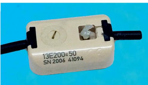
電気接続部位には、防湿のために必ず市販の電気絶縁用シリコングリースを塗布してください。
