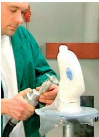
冷却後カットし取外します。
