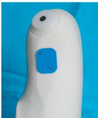
内ソケット用電極ダミー①の内側に付いている黄色の粘着テープは取外し、陽性モデルの電極の位置に釘2本で固定します。
