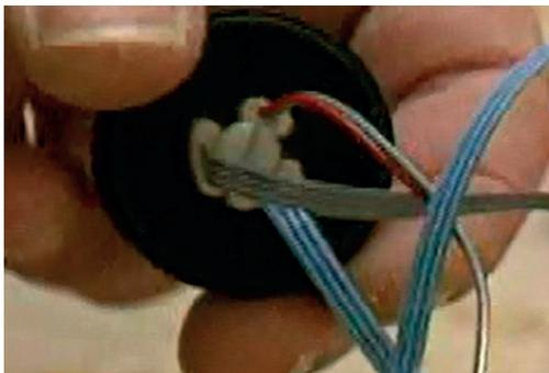
ケーブル類を接続した後、簡単に外れないように、プラスチックロックスクリュー⑤で固定します。
