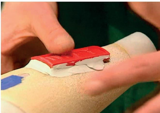
発泡樹脂の隙間や穴、バッテリーボックスダミーの固定に粘土を充填し形状を整えます。
