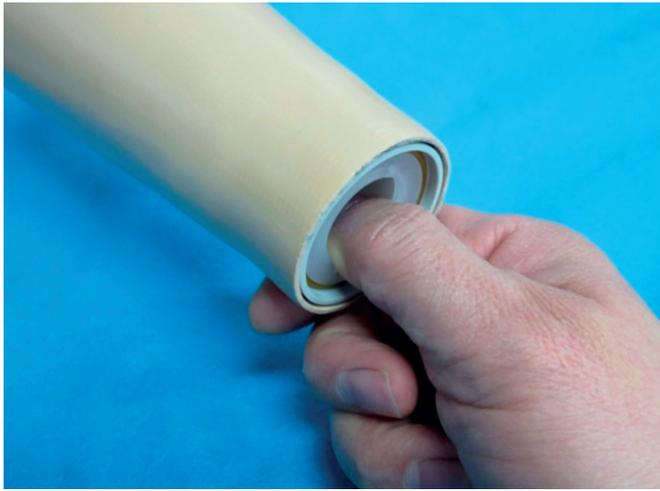
ジーゲルハルツが完全に硬化したら、テープを取外し、内側のダミーを引き抜きます。
