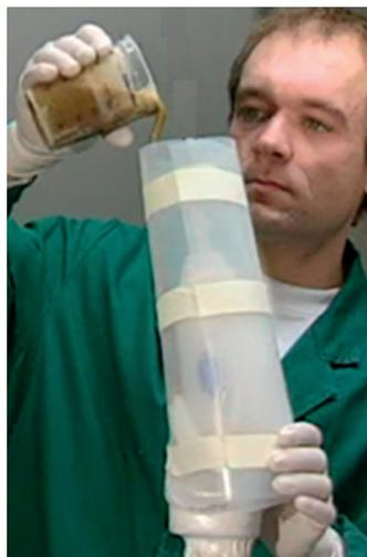
ソケットにPVCフィルムを被せて保護します。
