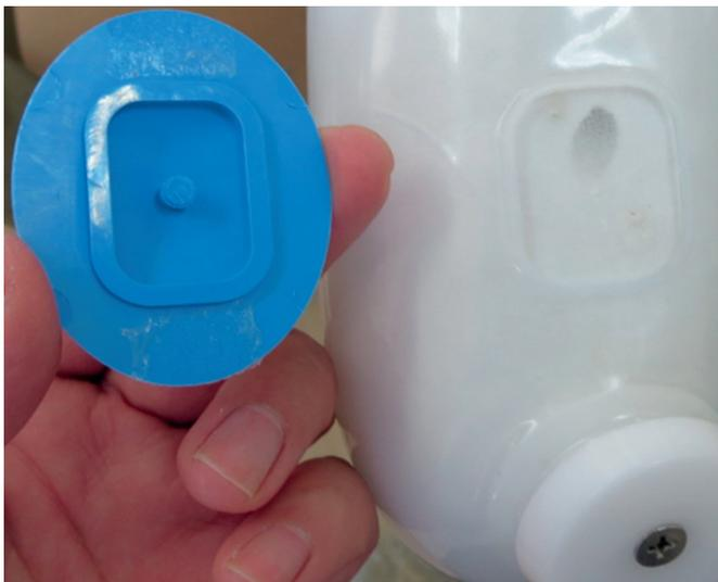
内ソケット用電極ダミー①①を取外します。
