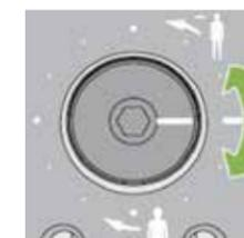
平地で確認します。3R85 は膝過伸展とその直後の膝屈曲でイールディングの抵抗がなくなり膝が軽く曲がります。遊脚相で膝が軽く曲がらない場合は、下段にあるダイヤルを 4mm レンチで反時計回り (- 方向) に回します。
