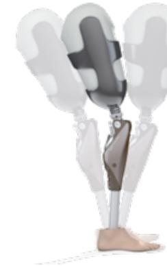
センサーの検知により、ユーザーが立位を維持しようとしているのか、歩き出そうとしているのか、Geniumが判断する。立位を維持する場面では、膝が曲がらないように自動的にロックがかかるため、Geniumに完全に体重をあずけることができる。重心が少しでも前に移動すればロックは解除されるため、スムーズに動き出すこともできる。平地だけでなく、斜面や不整路面においても、安心して立位を保持することができる。この機能により、断端をリラックスさせ、健側の負担も軽減する。
