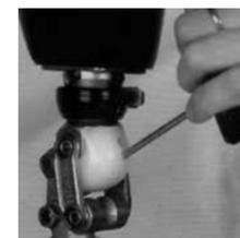
多軸の位置関係を変更し、瞬間回転中心を変えることによって安定性を調整できます。4mmの六角レンチを膝継手前方の穴に差し込み、ネジを回すことにより瞬間回転中心の位置が変化します。
